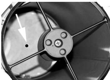
3. Wenn Sie durch die Tubusöffnung sehen, erblicken Sie den Hauptspiegel und darauf den Laserpunkt. Dieser muss mittig auf dem Hauptspiegel liegen. Durch Kippen des Fangspiegels kann man den Laser auf die Mittenmarkierung einstellen.
