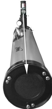
2. Stecken Sie dann den Laser in den 1,25" Auszug. Die Öffnung des Justierlasers mit der Zielscheibe muss dabei nach vorne in Richtung des Hauptspiegels zeigen.
