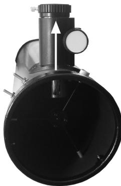
1. Legen Sie den Tubus waagrecht und drehen diesen so, dass der Okularauszug senkrecht nach oben zeigt.
