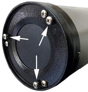
6. Der Laserstrahl muss jedoch exakt in sich zurückgespiegelt werden, d.h. er muss auf der Zielscheibe in der Vertiefung des LK1 genau mittig sein und im Loch verschwinden. Die Einstellung wird mit den Justageschrauben des Hauptspiegels vorgenommen. Dies erkennen Sie daran, dass sie ein wenig vorstehen.
