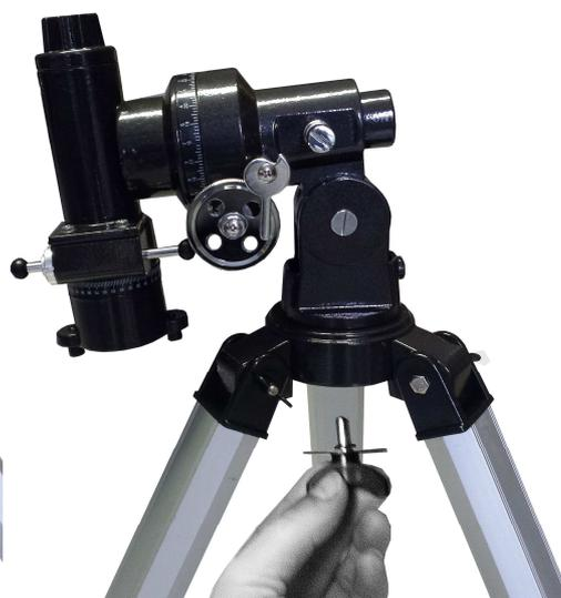
Lösen Sie dafür die beiden Schrauben an der Montierungsaufnahme für die Rohrschelle
