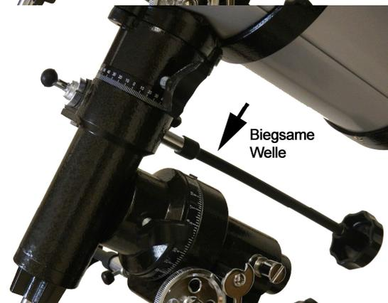
Die Justierung der Montierung ist wichtig, da beide Achsen in der Waage stehen müssen. Das bewirkt, dass das Teleskop, egal wie es steht, aufgrund einer einseitigen Überlastung nicht zur Seite kippt. Stellen Sie sich das wie eine Wippe vor: ist eine Seite mehr belastet, dann sinkt sie nach unten.
