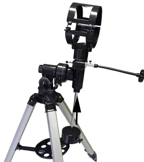
5. Legen Sie den Tubus in die Rohrschelle und schließen Sie die Rohrschelle seitlich. Achten Sie darauf, dass die Deklinationswelle in Richtung Okular zeigt.
