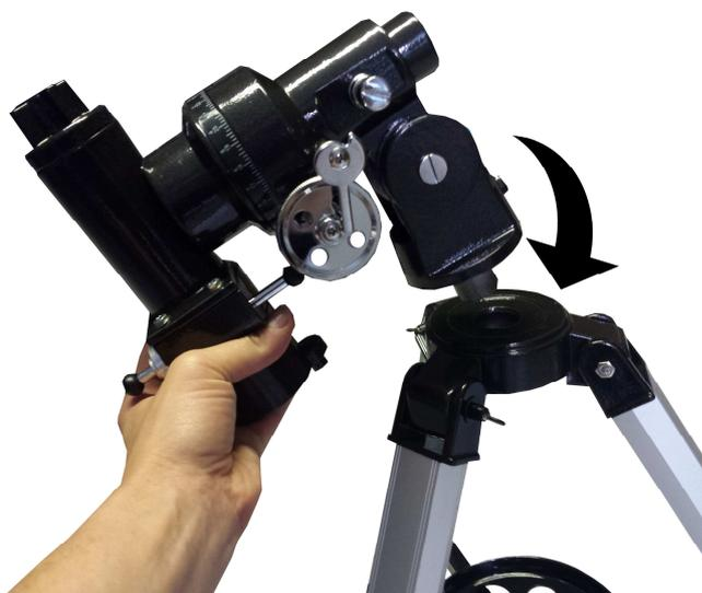
Drehen Sie ggf. die Deklinationsachse der Montierung nach oben und bringen Sie die Rohrschelle an.
