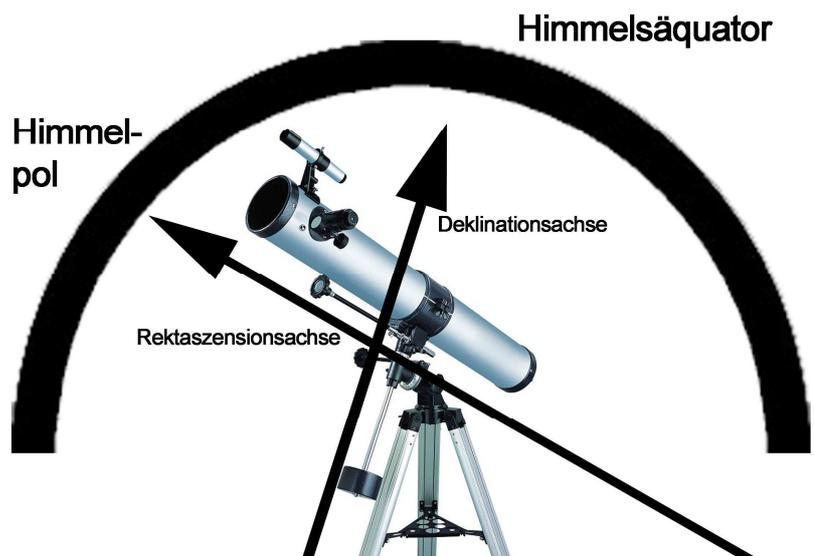
Der Umgang mit dieser Montierungsart muss erlernt werden, da diese so aufgebaut ist, dass Sie der scheinbaren Himmelsbewegung folgt.
