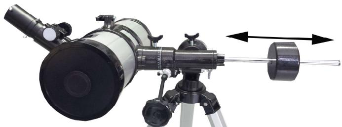
Nun haben Sie die Rektaszensionsachse justiert. Das bedeutet, dass diese Achse immer in Waage steht, egal in welcher Position Sie das Teleskop haben.
