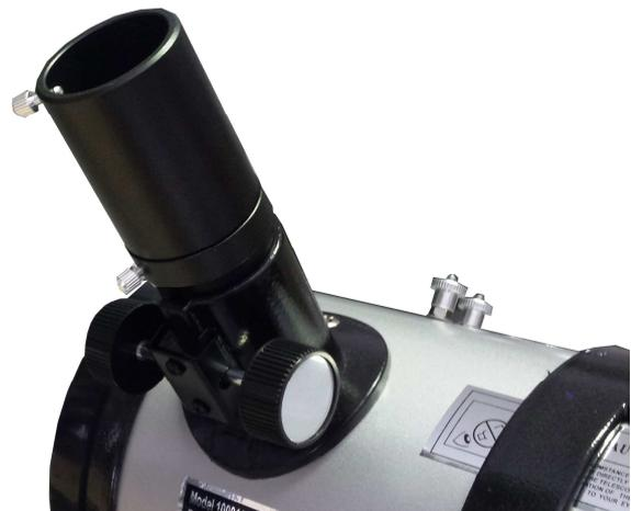
Lösen und entfernen Sie die Schraubenköpfe am vorderen Tubus und setzen Sie den Sucher auf die Schrauben.
