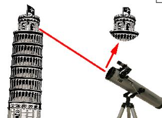
Schauen Sie durch das Sucherfernrohr. Wenn Sie nicht exakt das gleiche Bild sehen, stellen Sie das Sucherfernrohr ein. Am Sucherfernrohr finden Sie kleine Schrauben, mit denen Sie das Sucherfernrohr verstellen können, bis das Objekt im Sucherfernrohr exakt zu sehen ist. Dann haben Sie Teleskop und Sucherfernrohr parallel zueinander ausgerichtet. Falls Sie an den Sucher stoßen, müssen Sie den Vorgang wiederholen.
