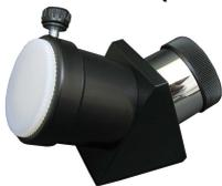
In den astronomischen Teleskopen ist das Bild auf den Kopf gestellt und seitenverkehrt. Das Zenitprisma richtet das Bild wieder auf, so dass man auch Naturbeobachtungen bequem vornehmen kann, korrigiert jedoch nicht die seitenverkehrte Darstellung. Es lenkt den Strahlengang um 90 Grad ab, wodurch der Okulareinblick bei Beobachtungen von Objekten in Zenitnähe erleichtert wird.
