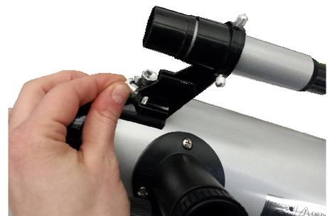
Schrauben Sie die Feststellschraube an der Polhöhenverstellung ein.
