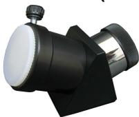
In den astronomischen Teleskopen ist das Bild auf den Kopf gestellt und seitenverkehrt. Das Zenitprisma richtet das Bild wieder auf, so dass man auch Naturbeobachtungen bequem vornehmen kann, korrigiert jedoch nicht die seitenverkehrte Darstellung. Es lenkt den Strahlengang um 90 Grad ab, wodurch der Okulareinblick bei Beobachtungen von Objekten in Zenitnähe erleichtert wird.
