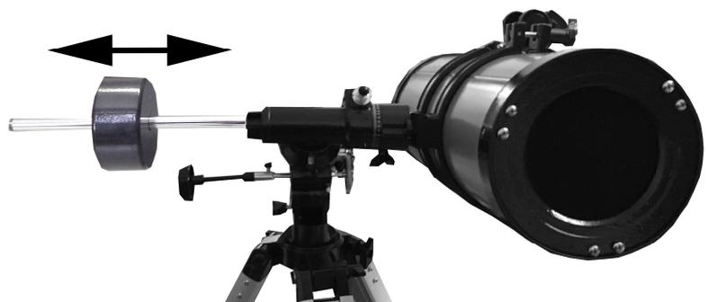
Nun haben Sie die Rektaszensionsachse justiert. Das bedeutet, dass diese Achse immer in Waage steht, egal in welcher Position Sie das Teleskop haben.
