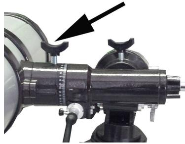
Um das zu beheben, öffnen Sie ein wenig den Verschluss der Rohrschelle, so dass sich der Tubus hin- und herschieben lässt. Verschieben Sie den Tubus so lange, bis er sich von alleine nicht mehr bewegt (also zu einer Seite absackt) und schließen danach die Deklinationsklemme wieder.
