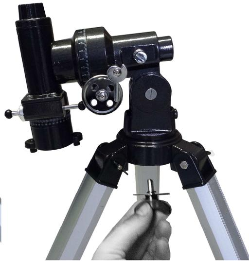
Drehen Sie ggf. die Deklinationsachse der Montierung nach oben und bringen Sie die Rohrschelle an.
