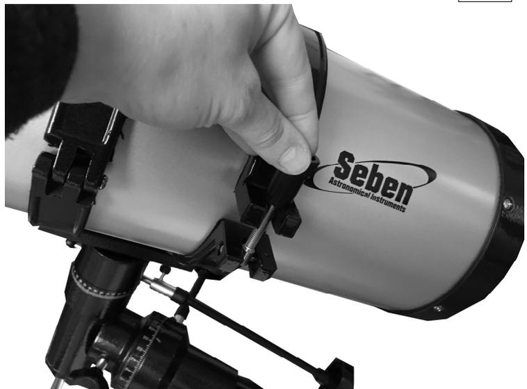
Lösen und entfernen Sie die Schraubenköpfe am vorderen Tubus und setzen Sie den Sucher auf die Schrauben.
