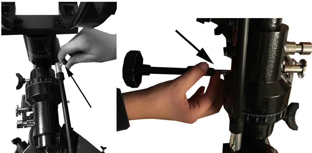
Nehmen Sie das Gewicht und schieben es auf die Gewichtsstange. Schrauben Sie die Stange von unten in die Montierung passend ein.
