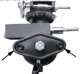
Setzen Sie durch die Löcher in der Rohrschelle die Schrauben wieder ein und ziehen diese fest.
