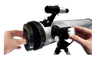
Bevor Sie Ihr erstes Ziel anvisieren, setzen Sie ein Okular mit möglichst kleiner Vergrößerung, also mit einer großen Zahl (z.B. 20mm), in den Okularauszug ein.
