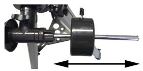
Nun haben Sie die Rektaszensionsachse justiert. Das bedeutet, dass diese Achse immer in Waage steht, egal in welcher Position Sie das Teleskop haben.
