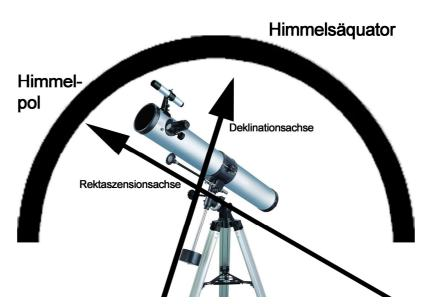
Der Umgang mit dieser Montierungsart muss erlernt werden, da diese so aufgebaut ist, dass Sie der scheinbaren Himmelsbewegung folgt.
