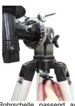
1. Bringen Sie die Rohrschelle an. Lösen Sie dafür 2. Setzen Sie nun die Rohrschelle passend auf. die beiden Schrauben an der Montierungsaufnahme für die Rohrschelle
