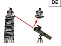
Schauen Sie durch das Sucherfernrohr. Wenn Sie nicht exakt das gleiche Bild sehen, stellen Sie das Sucherfernrohr ein. Am Suchfernrohr finden Sie kleine Schrauben, mit denen Sie das Sucherfernrohr verstellen können, bis das Objekt im Sucherfernrohr exakt zu sehen ist. Dann haben Sie Teleskop und Sucherfernohr parallel zueinander ausgerichtet. Falls Sie an den Sucher stoßen, müssen Sie den Vorgang wiederholen.
