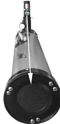
2. Mettez le laser dans le porte oculaire 1,25". Le trou du laser avec la cible doit être orienté en direction du miroir primaire resp. la coté fermée du tube.
