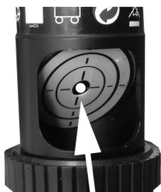
7. En tournant les vis d'ajustage le faisceau du laser se déplace sur la cible afin qu'il soit exactement au milieu.
