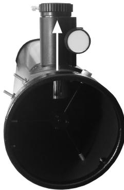
1. Positionnez le tube à l'horizontal la façon que le porte oculaire dirige perpendiculairement vers le haut,
