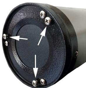
6. Il faut que la réflexion du faisceau laser soit centré exactement au milieu de la cible du collimateur LK1 veut dire disparu dans le trou. L'ajustage se fait par les vis de réglage du miroir primaire saillant vers l'extérieur.
