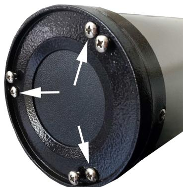
8. Maintenant il ne faut que visser les vis de fixation de façon lentement. Ce sont les vis qui ne saillissent pratiquement pas. Veillez que le faisceau reste exactement au milieu.
