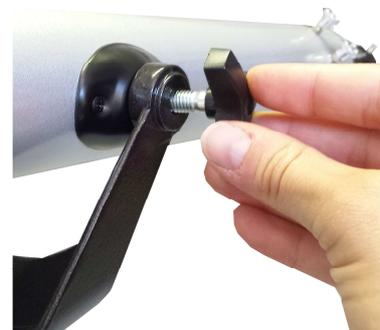
Maintenant, faites glisser la tige de réglage (1) dans la pièce d'accueil (2) à la Monture. Assurez-vous que l'œil de fixation de la tige (3) pointe vers l'ouverture du tube. Poussez la vis à travers le trou (3) dans le filetage et serrez la.
