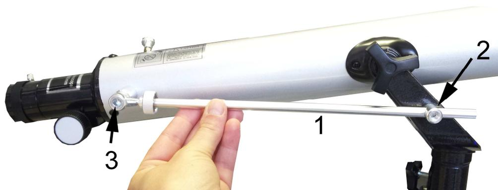
Desserrer et retirer les vis de boulons sur le tube avant et régler le viseur sur les vis.
