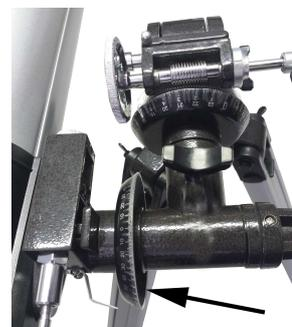
Per correggerlo, aprire leggermente la chiusura dell'anello del tubo del telescopio, in modo che il tubo possa essere spostato avanti e indietro. Spostare il tubo fino a che non si muove più da solo (il che significa che non crollerà verso il basso da un lato) e poi richiudere il morsetto declinazione.
