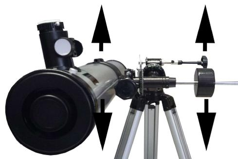
A seconda se il tubo o il contrappeso sprofonda, spostare il contrappeso sull'asta per raggiungere un equilibrio.
