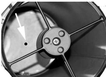
3. Si se mira a través de la abertura del tubo, he aquí el espejo primario y el punto láser en él. Esto debe estar ubicado centralmente en el espejo primario. Por la inclinación del espejo secundario se puede ajustar el láser centralmente.
