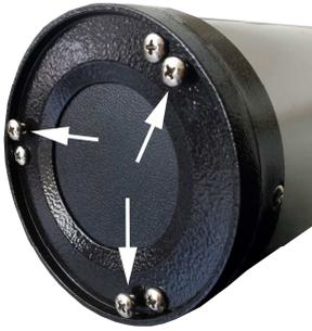
6. Sin embargo, el rayo de retorno que rebota del primario debe ser exactamente centrado en el espejo primario, en el blanco en el hoyo del LK1 y desaparecer en el agujero. El ajuste se realiza con los tornillos de ajuste del espejo primario. Se puede reconocer ellos facilmente por el hecho de que están un poco desistados de la base.
