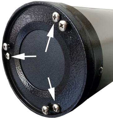
8. Para terminar, apriete gradualmente los tornillos de fijación. Se puede reconocer los tornillos de fijación por el hecho de que no o casi no sobresalen de la base. Asegúrese de que el punto láser no sale fuera del agujero.
