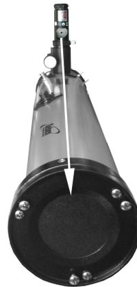
2. Se mete el colimador láser en la abertura de 1,25 pulgadas. La abertura del colimador láser (el blanco) debe apuntar hacia el espejo primario hacia adelante.
