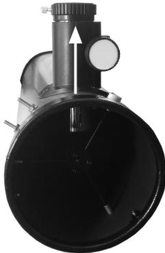
1. Se coloca el tubo de telescopio horizontal y gira la abertura del ocular verticalmente hacia arriba.
