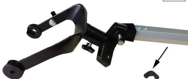
Ahora, el primer pie estará montado y esto debería ser ilustrado como en esta imagen. El pie del trípode se fija en la montura (azimutal) placa de trípode (Mesa paralela), vinculada (1) y la inclusión para el soporte del ocular (azimutal), la bandeja del ocular (mesa paralela) orientada hacia el interior (2).
