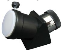
En los telescopios astronómicos, la imagen está al revés e invertida. El prisma de zenit ajusta la pantalla en la parte posterior, de manera que pueda hacer igualmente las observaciones de la naturaleza con facilidad, pero no corrige la imagen invertida. Se desvía la trayectoria del haz de 90 grados, lo que facilita las observaciones oculares de los objetos cerca del zenit.
