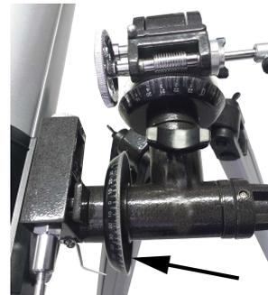
Para corregir eso, abra ligeramente el cierre del anillo del tubo del telescopio, para que el tubo pueda ser movido a un lado y otro. Mueva el tubo hasta que no se mueva mas solo (es decir que no se hunda de un lado) y luego cierre la pinza de declinación de nuevo.
