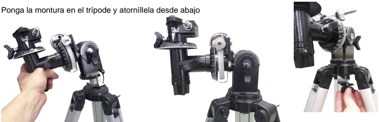
Gire el eje de declinación de la montura hacia arriba, de ser necesario, y una el aro del tubo del telescopio. Para hacer eso, destornille ambos tornillos del encaje de montaje para el anillo del tubo del telescopio.
