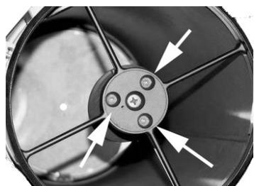
4. Ruotando le viti di regolazione lo specchio secondario viene inclinato. Il punto laser migra attraverso lo specchio principale.
