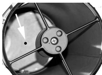
3. Quando si vede attraverso l'apertura del tubo, si vede lo specchio principale e il punto laser su di esso. Questo deve essere situato in posizione centrale sullo specchio principale. Inclinando lo specchio secondario è possibile regolare il laser al segno centrale.
