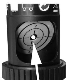
7. Ruotando le viti di regolazione il punto laser si muove sul bersaglio finché è centrato.
