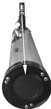
2. Inserire quindi il laser nel "estratto 1,25". L'apertura del laser di allineamento al disco di destinazione deve essere rivolta nella direzione dello specchio principale ovvero il lato chiuso del tubo.
