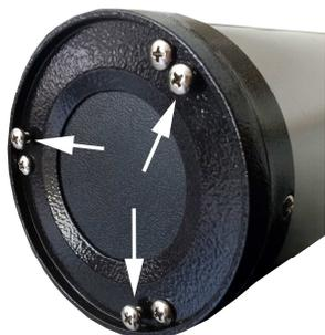
6. Il raggio laser, tuttavia, deve essere correttamente ripreso in se stesso, vale a dire che deve essere sul bersaglio nella cavità del LK1 esattamente centrata e scomparire nel foro. La regolazione viene effettuata con le viti di regolazione dello specchio principale. Si riconoscono perché sporgono un pò.
