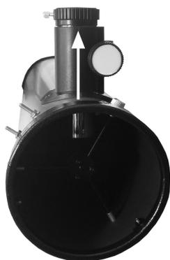
1. Inserire il tubo orizzontale e ruotarlo in modo che l'oculare sia rivolto verticalmente verso l'alto.
