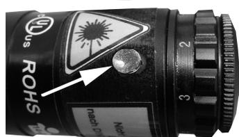
9. Regolazione del collimatore laser
